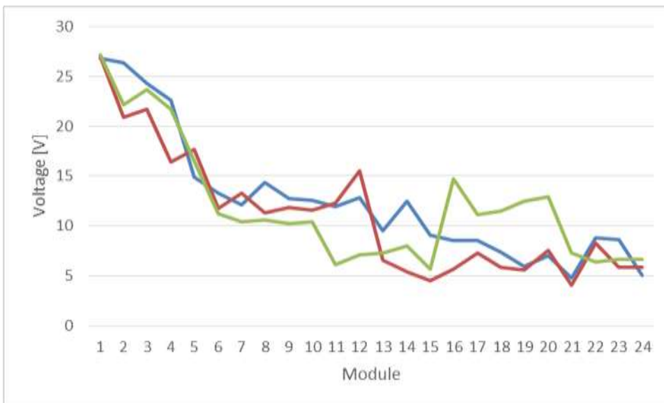
Abbildung 2 Modul-Leerlaufspannung von 3 Strings an einem Wechselrichter
